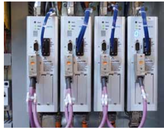
Servocontroller vom Typ CMMP steuern als Slaves die drei Motoren am Tripod und die Frontend-Dreheinheit an.
