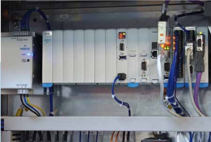
Die Robotiksteuerung CMXR-C2 steuert als Master die Servocontroller für den Tripod und die Dreheinheit des Greifers.
