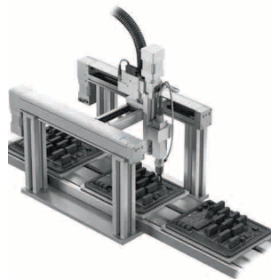
Verschrauben von Elektronikbauteilen
