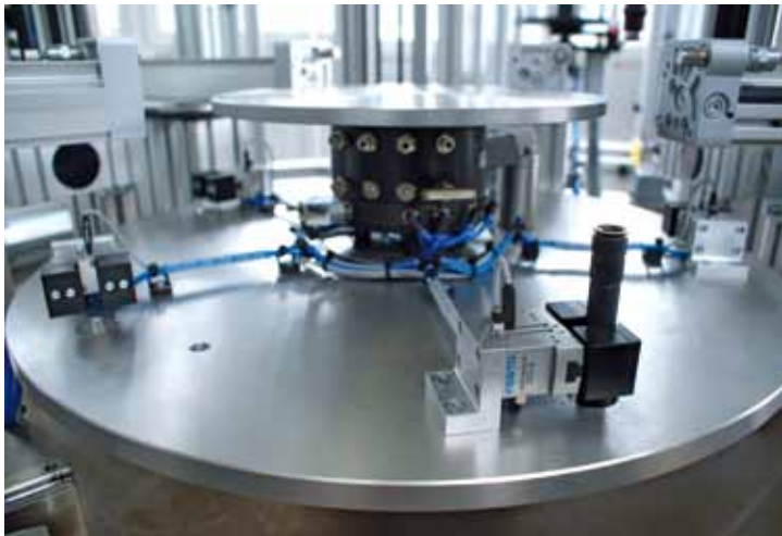
Am Drehtisch sorgt ein HGPT-Parallelgreifer für den sicheren Halt des Rohres während Transport und Bearbeitung.
