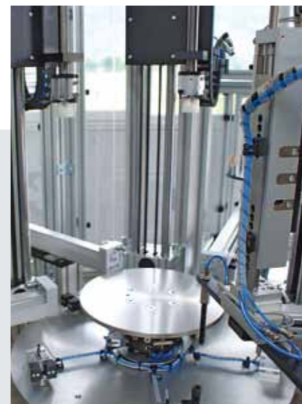
Blick ins Herz der Maschine – insgesamt fünf Stationen werden vom Rundtisch angefahren.
