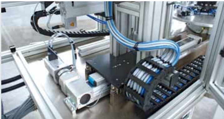
Auf der Station 4 wird der gesamte Bürstenantrieb von einem Elektrozyylinder EPCO ausgelenkt. Die elektrische Zahnriemenachse ELGA und eine ELGR-Zahnriemenachse sorgen für den Positionsausgleich der Bürstenspitze.
