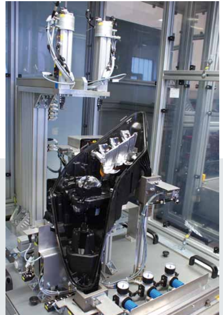
DSL-Schwenk- Lineareinheiten ziehen am Leuchtmodul und prüfen den festen Sitz.
