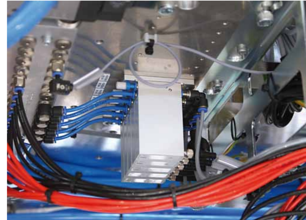
Piezodruckregelventile VEAB steuern die Zylinder im Schweißwerkzeug. Vorteil: permanente Prozessdatenüberwachung und volle Flexibilität bei der Einstellung des Schweißdrucks.
