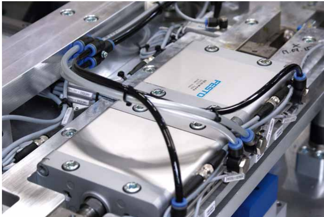
DZF-Flachzylinder spannen die Niederhalterahmen zu Beginn der Bearbeitung fest.
